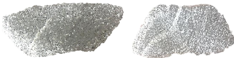
Фиг. 2.7. Заряди от композитно гориво с настъпил растеж и агломерация на кристалите амониев перхлорат
