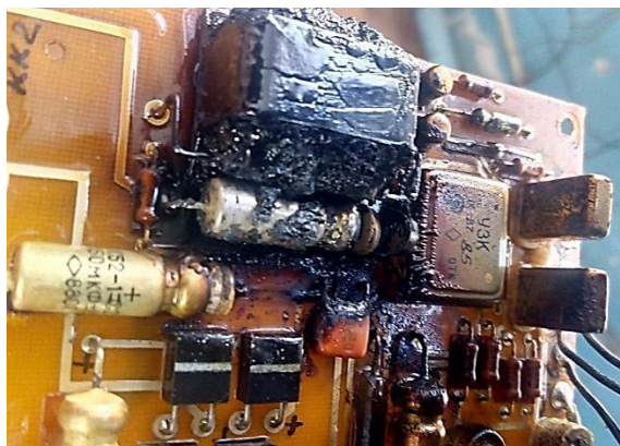
Фиг. 2.9. Последствия от възникнало пренапрежение в електронен управляващ блок на АУР
