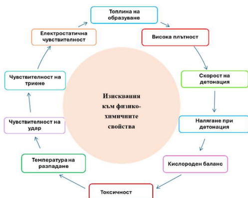
Фигура 4. Изисквания към физико-химичните свойства на новите високоазотните съединения.
